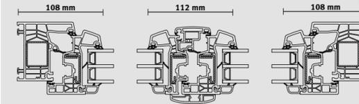
Pour une porte-fenêtre avec serrure à fouillot de 40 mm, masse centrale réduite de 152 mm.
